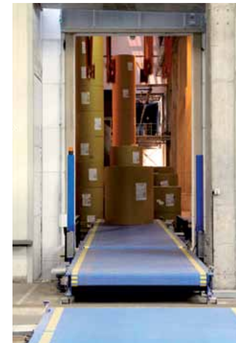
▲ Передача рулона на транспортер
